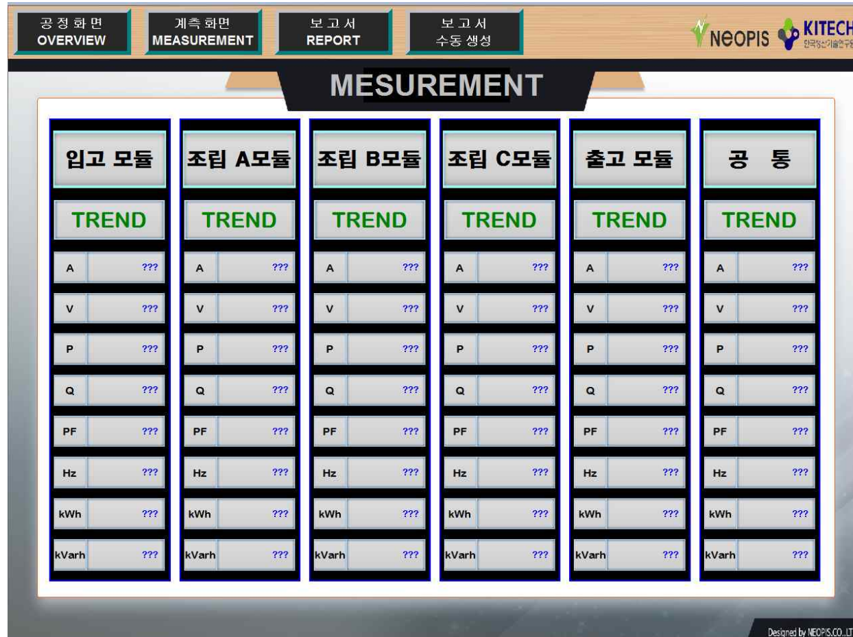
< 전기 모니터링 SCADA 화면 (예제) >
